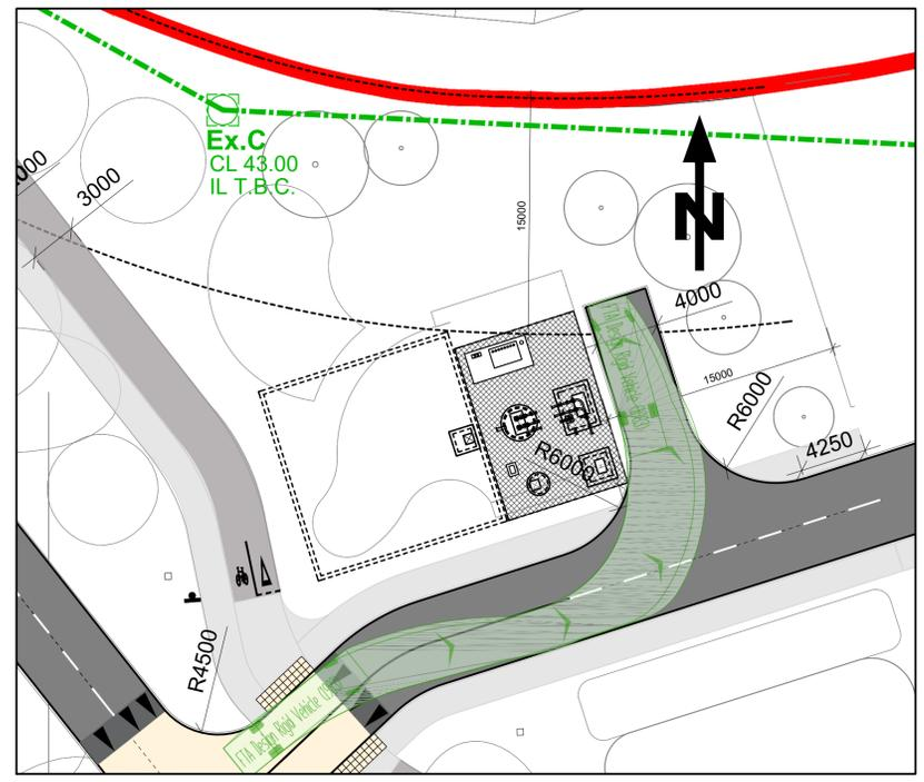
**LIFTING STATION LOCATION ENTRY VEHICLE TRACKING PLAN**
