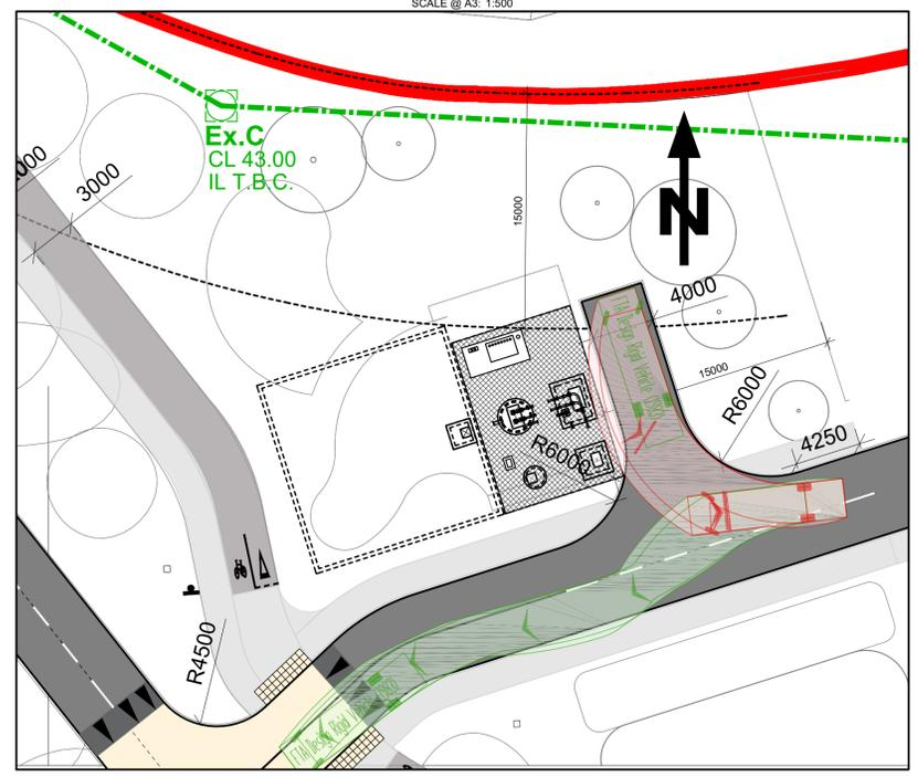
**LIFTING STATION LOCATION EXIT VEHICLE TRACKING PLAN**
